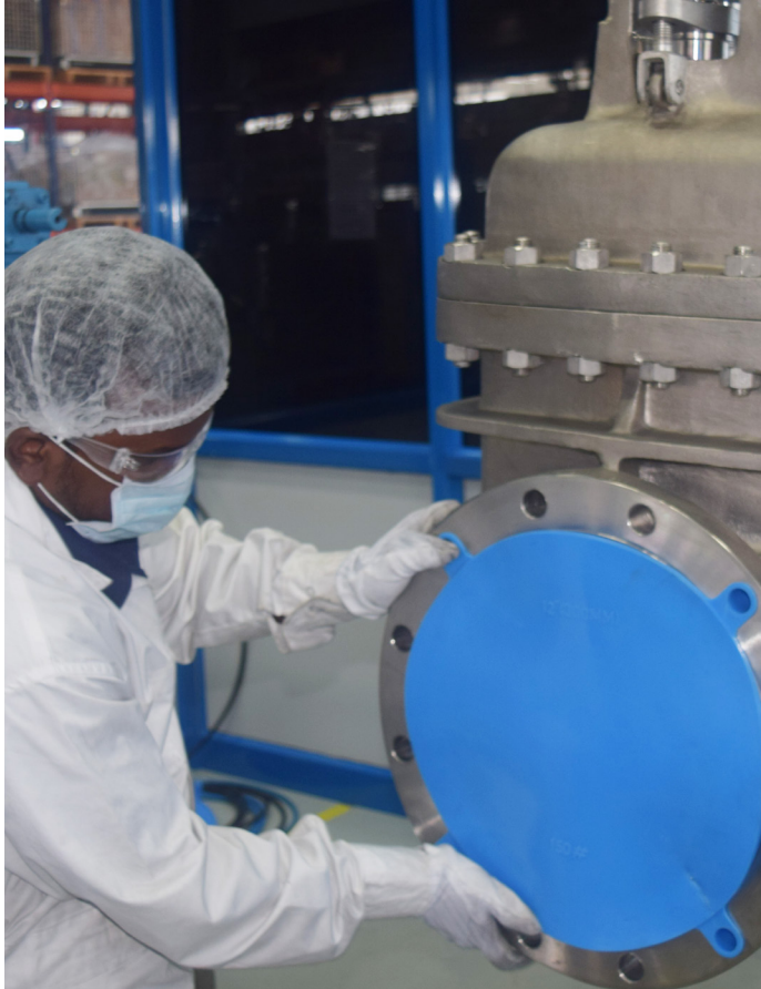
Robinet-vanne nettoyé à l'oxygène.
