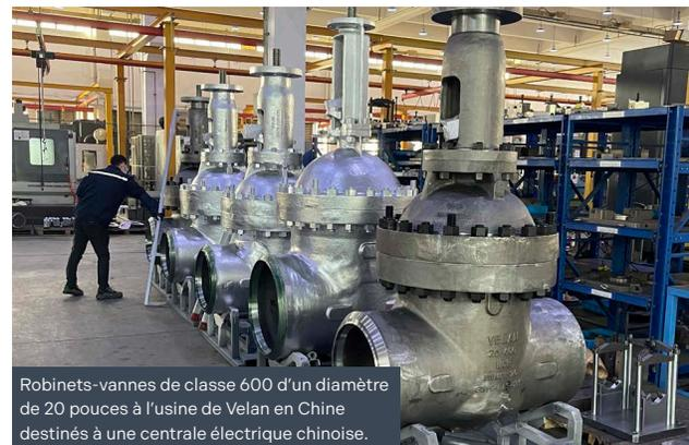
Robinet-vannes de classe 600 d'un diamètre de 20 pouces à l'usine de Velan en Chine destinés à une centrale électrique chinoise.
