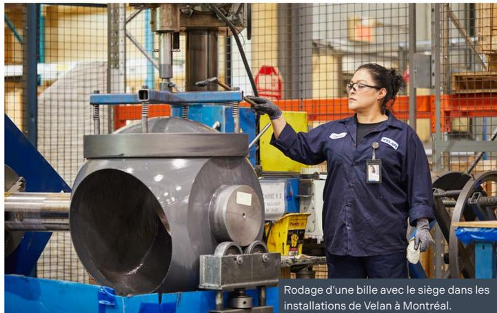
Rodage d'une bille avec le siège dans les installations de Velan à Montréal.
