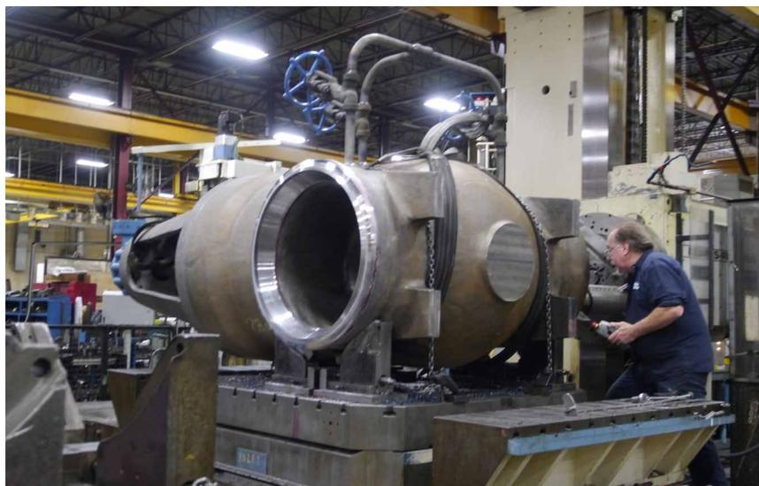
Robinet-vanne en acier au carbone de 36 pouces (914 mm) de classe 900.
